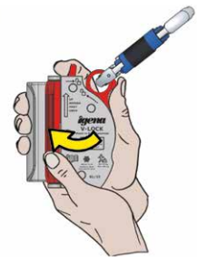
3. Rotación de la compuerta e introducir el cable dentro del anticaídas.
